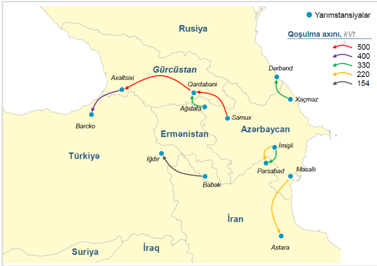
Şəkil 4. Elektrik enerjisi ixracı üçün elektrik qovşaqları
